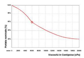
Durante el bombeo de un fluido con una viscosidad de 6000cPs, la capacidad de la bomba se reduce al 60% de su valor nominal (100% = agua). Válido para las bombas de ¾" y más grandes.
