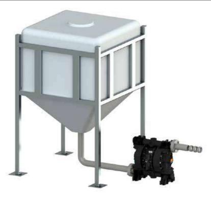
Bomba instalada después de las tolvas para fluidos de alta viscosidad (la altura de la tolva ayuda a la bomba a desplazar el fluido. Bomba instalada después de las tolvas para fluidos de alta viscosidad (la altura de la tolva ayuda a la bomba a desplazar el fluido.
