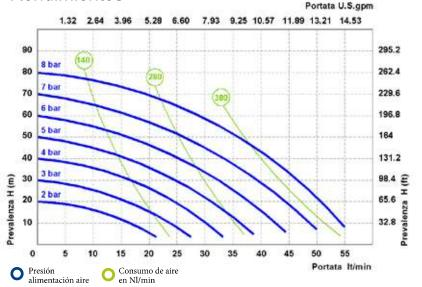
Las curvas y los rendimientos se refieren a las bombas con aspiración sumergida e impulsión con boca libre, con agua a 20  $^{\circ}$ C, y varían según el material de fabricación.
