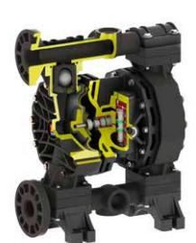
Distribuidor neumático anti atascamiento y anti congelación que no necesita lubricación, este sistema garantiza una larga duración y un bajo consumo de aire.
