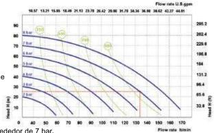
En el punto A, la bomba necesitará una presión de alimentación del aire de alrededor de 7 bar.
